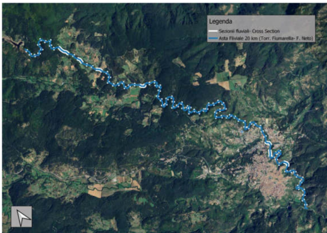
Figura 6-2- Modello idraulico su Ortofoto
